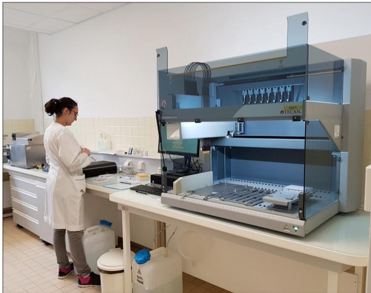
Préleveur multi-aiguilles TECAN sur microplaques, avec un système de perçage des opercules.
