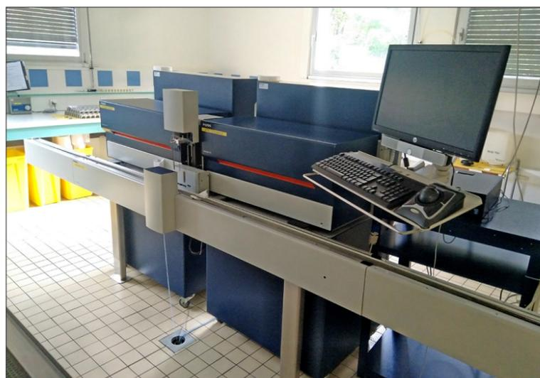
Analyseur infrarouge FOSS couplé à un compteur de cellules.
